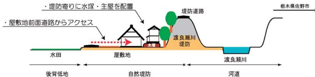
図 3-2-1 西岡新田地区の典型的な断面構成
