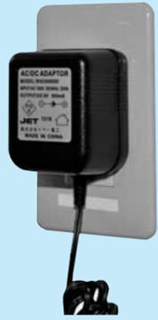
現在ご使用のACアダプタは、通常約45度程度の発熱がありますが、使用に問題はありません。ACアダプタ本体に、内蔵された電圧・電流を安定的に制御するレギュレータという装置が熱を持ちますが、仕様上の許容温度が約70度（室温25度の場合）で、機能上発火などの心配はありません。
